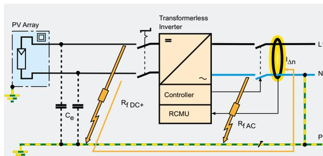
RCMU en inverter fotovoltaico sin separación
